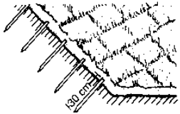
(۳) سیاهخاک (کلوخ) روی شیبی بیشتر از ۱:۲ که با سیخ چوبی ثابت شده است 10-5-75-65
